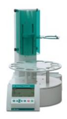
Компактное и экономичное устройство для автоматического потенциометрического титрования в режимах титрования до конечной точки (SET), монотонного титрования до точки эквивалентности (МЕТ) и динамического титрования до точки эквивалентности (DET).
